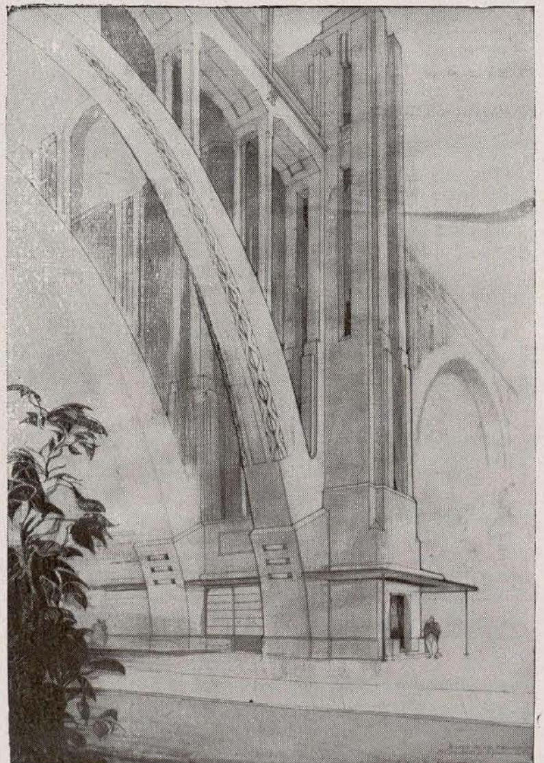
Detalle de una pila con ascensor y arranque de los arcos.
