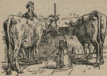
Dicho aparato consiste en un motor eléctrico, que por medio de un tubo aplicado á las ubres de las vacas produce una succión poderosa en muchas reses á la vez y con la misma intensidad, llenando en pocos minutos los recipientes, lo cual, como se ve, simplifica grandemente la operación, evitándose personal, que con esto resulta inútil.
