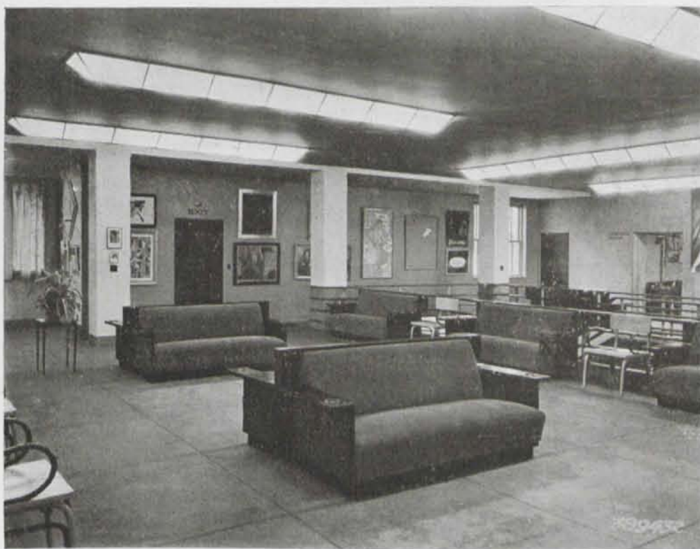
Iluminación interior a base de cristal opalino.
