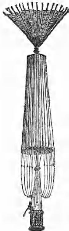
paracaídas una serie de sacudimientos que felizmente ningún resultado funesto produjeron. Posteriormente han logrado evitarse practicando en el centro del paracaídas un tubo de alguna elevación por el que el aire puede evadirse sin impedir la resistencia que disminuye la rapidez de la caída.
