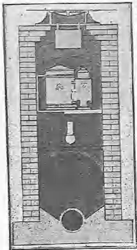
APARATO REEVES PARA LA VENTILACIÓN DEL ALCANTARILLADO
