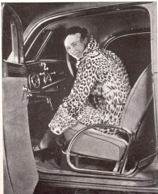
LOS ASIENTOS DEL NUEVO DE SOTO AERODINAMICO están contruidos en acero con un baño especial de cromo. La colocación de los mismos ha sido hábilmente dispuesta para facilitar la acción del que maneja.
