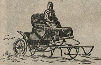
El invento se debe á un automovilista americano J. K. Flood, que tuvo la idea de convertir en trineo automóvil uno de sus carruajes, reemplazando las ruedas delanteras por un ingenioso sistema de patines.
