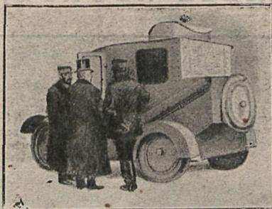
blindadas de acero, montada sobre un chasis 30 H. P. C. G. V. de los corrientes y que en su parte posterior lleva una torre giratoria de nueva invención, también blindada, con una ametralladora capaz de lanzar hasta 2.000 metros, 60 proyectiles por minuto.
