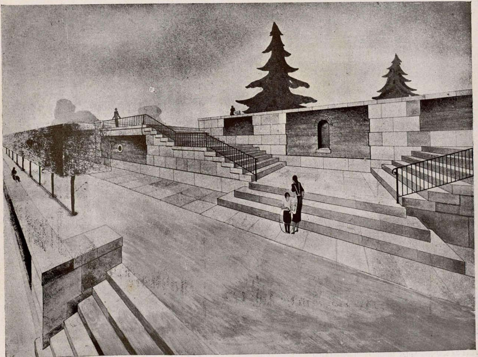
Escalera secundaria de los jardines de la República, para salvar con poco gasto los grandes desniveles de esa parte del terreno.
