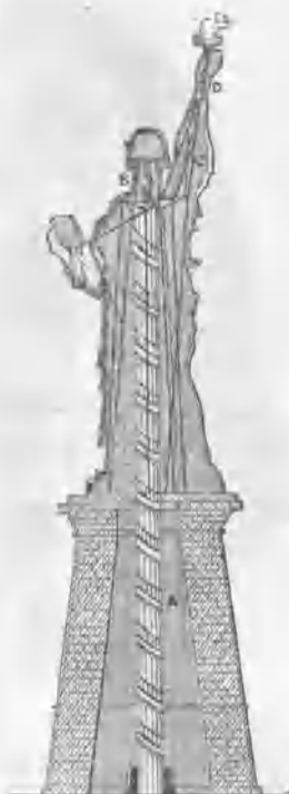
Vista de las escaleras interiores de la estatua de la libertad.—A. Escalera en espiral construida dentro de una columna.—B. Escalera para entrar á la cabeza de la estatua.—C. D. Escalera para subir al balcón circular construido alrededor de la antorcha.
